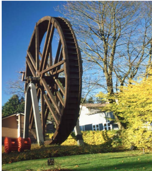
Abbildung 7 11,50 m großes Kunstrad. Nachbau am Schacht Wilhelm II. (Betriebshof der Harzwasserwerke) in Clausthal-Zellerfeld
